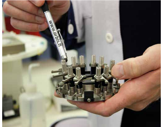
Hiontalaitteen APC-hiontateline, jossa liittimet ovat 8 asteen kulmassa
